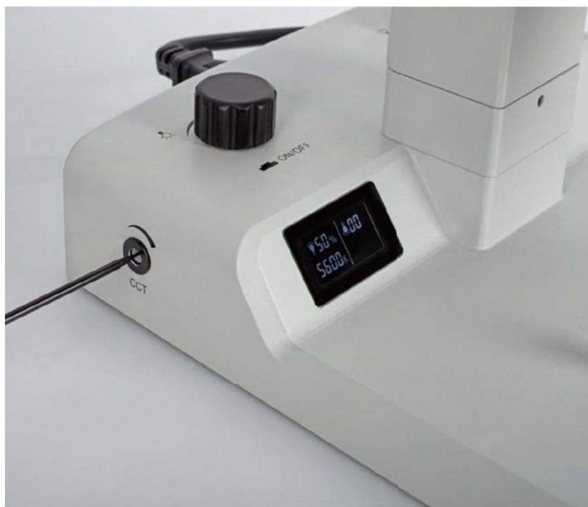
Регулировка цветовой температуры с шагом 100 К
