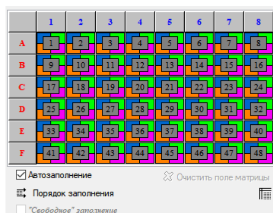
Рис.48 Схематическое расположение пробирок в матрице термоблока
