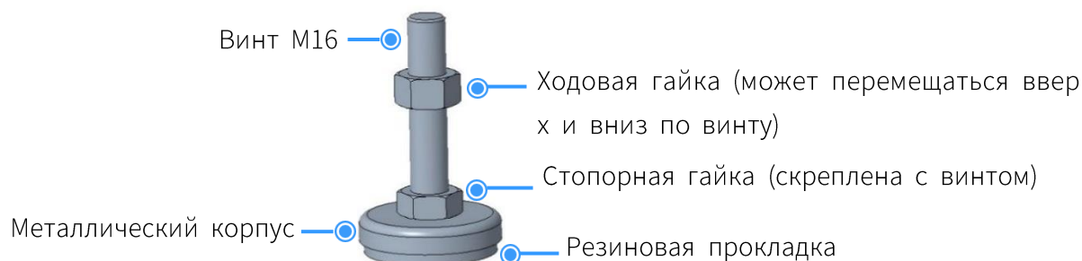
Рисунок 4-2 Конструкция выравнивающей опоры
